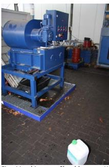
Eine Maschine zum Shreddern von Kunststoffbehältern. Trotz Vorsichtsmaßnahmen kam es öfter zum Verschleppen von Ölresten aus den Kanistern
