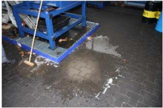
Nach einer Einwirkzeit von ca.5min kann die Fläche abgespült werden. Es ist darauf zu achten, dass die Flüssigkeit über einen Ölabscheider entsorgt wird.
