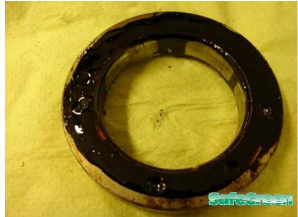
Stark verschmutzte Teile, Flansche aus dem Raffineriebetrieb. Bei den Verschmutzungen handelt es sich zu meist um Rückständen von Rohöl.
