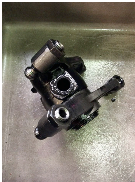
Ausgebautes Motorteil verölt und verrostet
