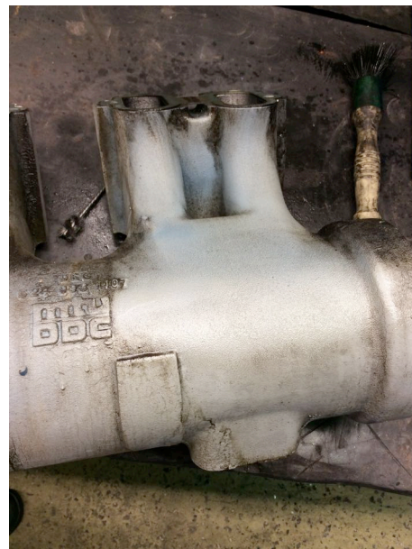
Mit RSG-3034 SafeGreen KaltEntfetter NG abgespült und Sauber und trocken
