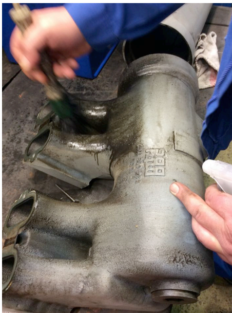
Reinigung eines Motorenteiles mit einem Pinsel
