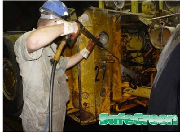
Mittels Hochdruckreiniger werden die Verschmutzungen entfernt.
