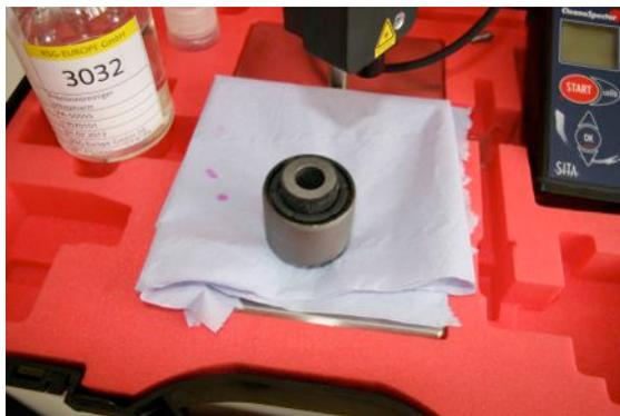
Die Manschetten und Dichtungen wurden nicht angegriffen. Da RSG-3032 SafeGreen® Präzisionsreiniger keine Weichmacher entzieht, bleibt das Material flexibel und erfüllt weiter seine Aufgaben
