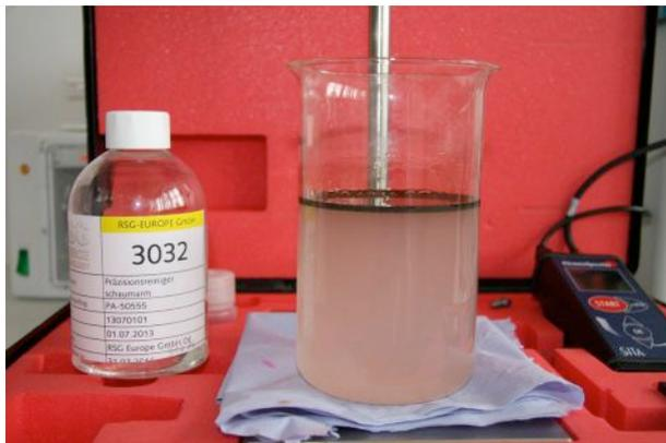
Nach 3 Minuten hat sich der Schmutz und das Öl von der Lösung getrennt. Daher empfehlen wir beim Einsatz der kennzeichnungsfreien sehr gut demulgierenden Reinigungslösung RSG-3032 SafeGreen PRÄZISIONSREINIGER einen Ölabscheider im System der Reinigungsanlage einzubauen
