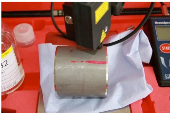
Nach der Reinigung mit RSG-3032 wurde ein Oberflächenspannungstest von 44 mN/m angebracht (rote Kennzeichnung) Das Ergebnis des SITA Cleano Spector Test ergab ebenfalls eine Reinheit von 100% .
